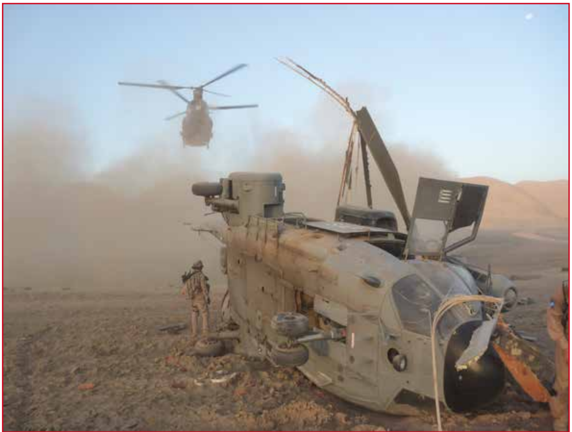
Aproximación del Chinook al POI ( point of incident ) llevando a los equipos que prepararían el Super Puma accidentado para su traslado en carga externa.
