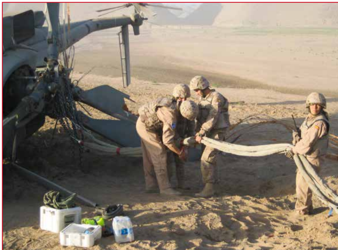
Preparación de la carga externa. Obsérvese la robustez de las eslingas
